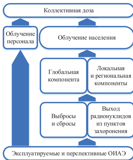
Рис. 14. Номенклатура источников поступления радионуклидов в окружающую среду и путей облучения персонала и населения
