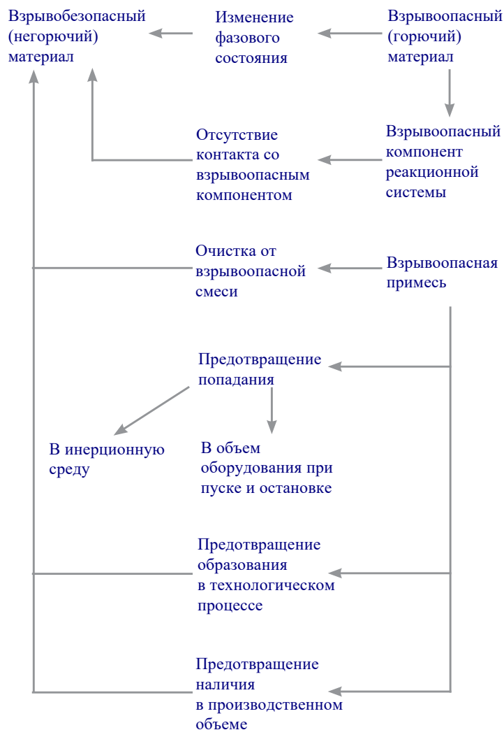
Рис. 42. Схема направлений создания условий для исключения возникновения взрыва в технологическом процессе
