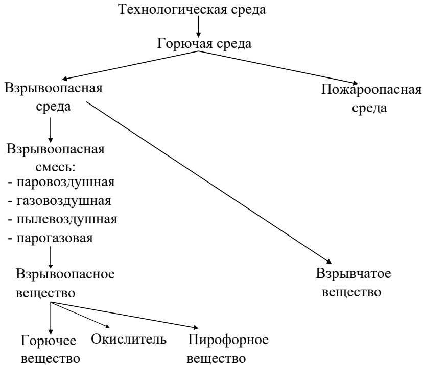
Рис. 19. Взаимосвязь терминов, относящихся к пожаровзрывоопасности веществ и материалов
