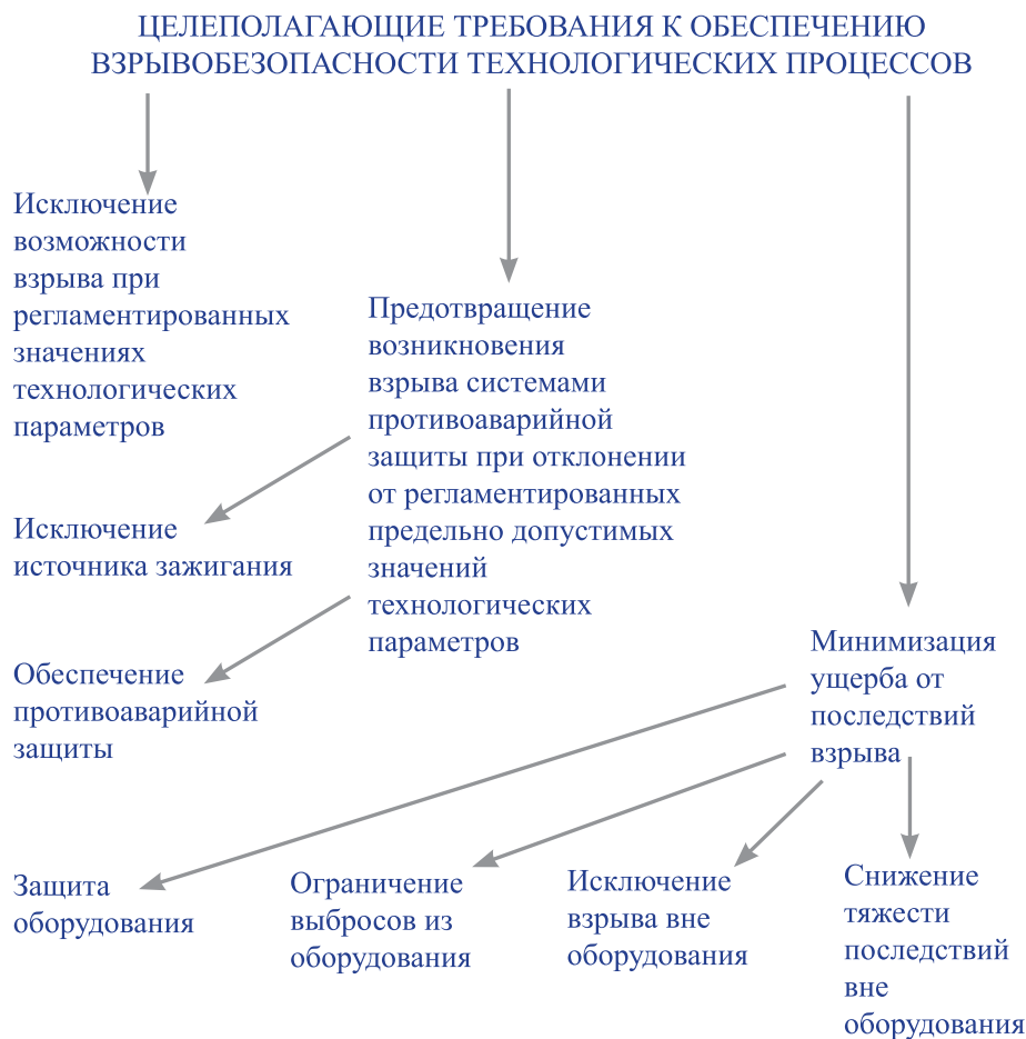
Рис. 41. Общая структура целеполагающих требований к обеспечению взрывобезопасности технологических процессов
