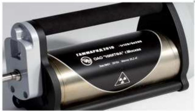
Рассмотрим пример категорирования радионуклидного гамма-дефектоскопа серии «Гаммариd 2010», в состав которого входит закрытый радионуклидный источник излучения на основе иридия-192 с активностью 200 Ки (Кюри) =  $3,7 \cdot 10^{10}$  Бк) на этапе транспортирования.
