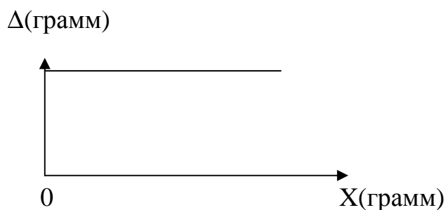
Рис. Пб.1. Зависимость погрешности измерения от измеряемой величины.
