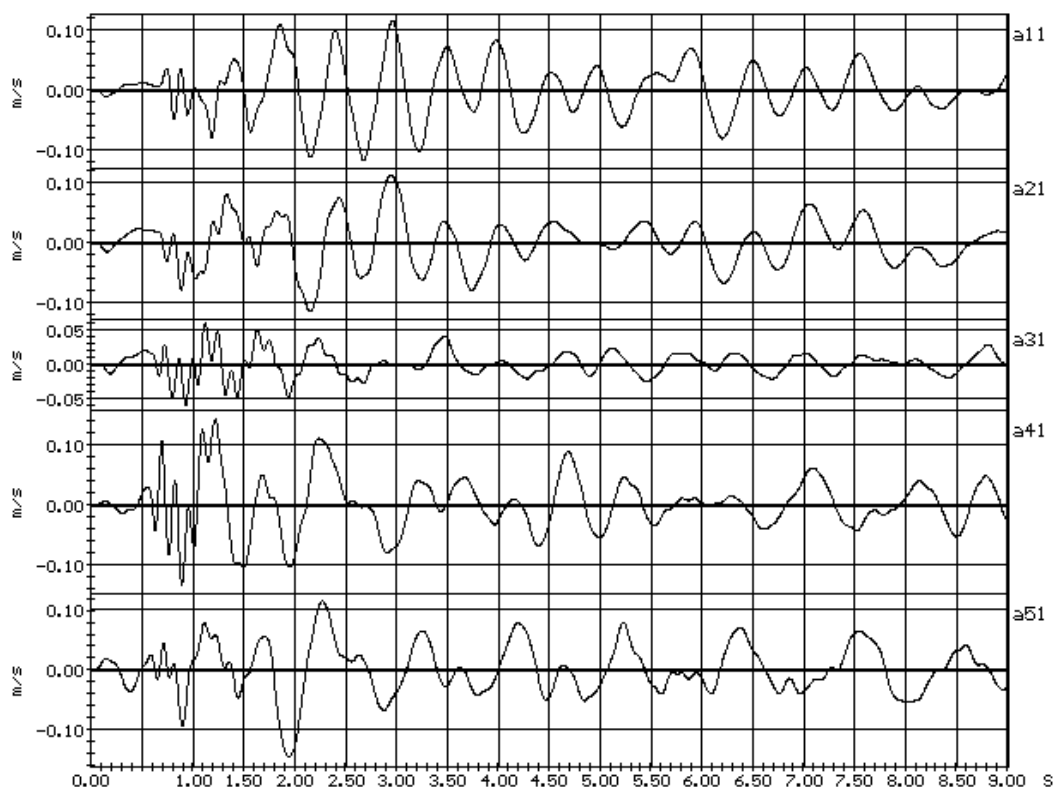
Рис. 1.3. Колебания здания при ударе У1
