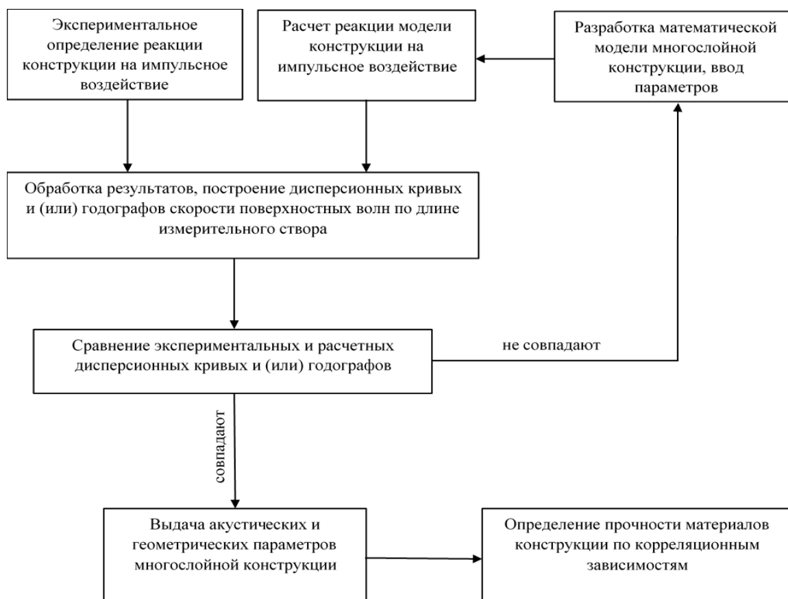
Рис. 2.1. Блок-схема алгоритма контроля состояния многослойных конструкций.
