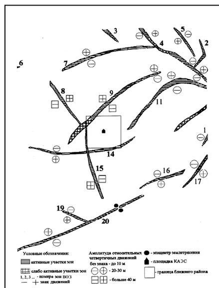
Рис. 1. Геодинамические условия района размещения площадки Калининской АЭС. Фрагмент схемы геодинамически активных зон района размещения площадки Калининской АЭС. Масштаб 1 : 500 000
