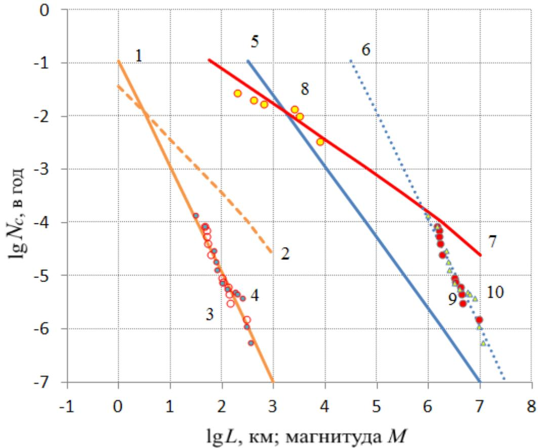
Рис. 5. Сравнение прогнозных графиков повторяемости магнитуд, рассчитанных согласно принятой модели, и наблюдаемых графиков повторяемости магнитуд, рассчитанных согласно каталогу исторических землетрясений
