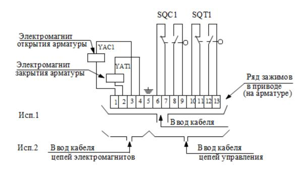
Примечание. Для случая применения электромагнит ов постоянного тока со встроенными выпрямителями их внутренняя схема соединения должна указываться в ТУ на арматуру.
