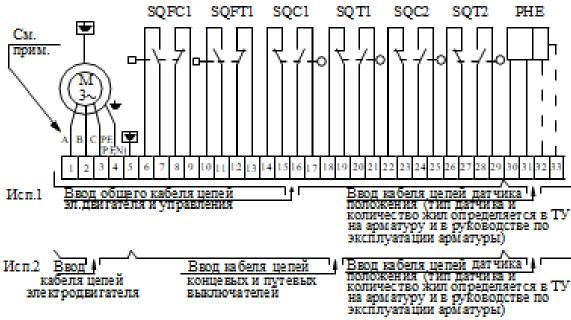
М-электродвигатель трехфазный а синхронный
