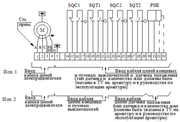
М-электродвигатель одно- или трехфазный асинхронный (тип электродвигателя определяется в ТУ)
