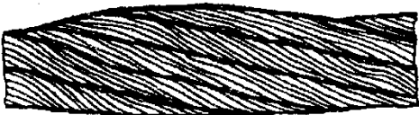
Рис. 13. Местное увеличение диаметра каната
