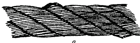
Рис. 1. Обрывы и смещения проволок каната крестовой свивки
