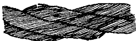
Рис. 1. Обрывы и смещения проволок каната крестовой свивки
