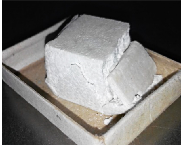
Рис. 20. Фотография образца МКФ компаунда после определения прочности на сжатие при исследовании устойчивости к термическим циклам (Куликова, С. А. Имобилизация актинидсодержащих радиоактивных отходов в магний-калий-фосфатную матрицу: дис. ... канд. хим. наук: 02.00.14 / С. А. Куликова. – Москва, 2021. – 113 с.)
