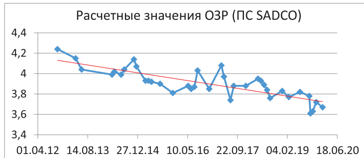
Рис. 19. Расчетные значения оперативного запаса реактивности, полученные в составе информационно-измерительной системы «СКАЛА»
