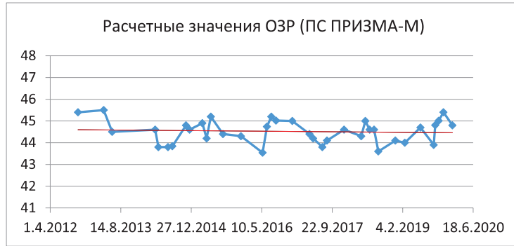
Рис. 18. Оперативные расчетные значения оперативного запаса реактивности, полученные по программному средству ПРИЗМА-М
