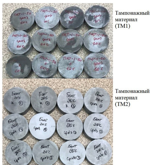
Рис. 34. Образцы тампонажных материалов, подготовленных для испытаний
