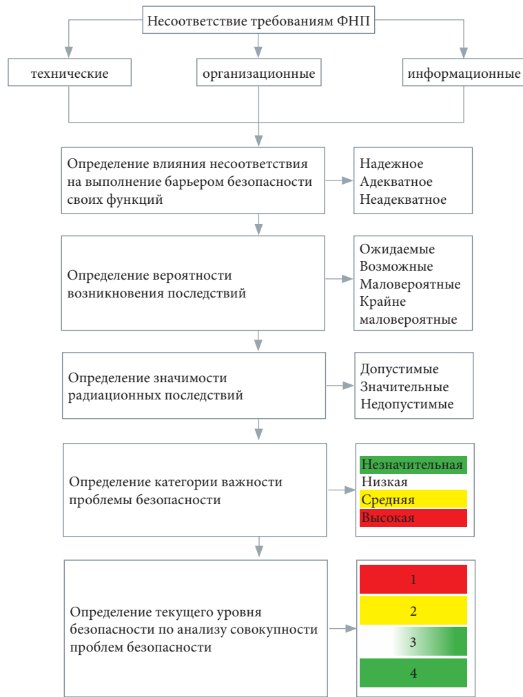
Рис. 13. Алгоритм определения текущего уровня безопасности при анализе отступлений от требований ФНП
