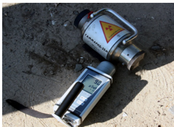
Рис. 8. Обнаруженный бесхозный блок гамма-источника
