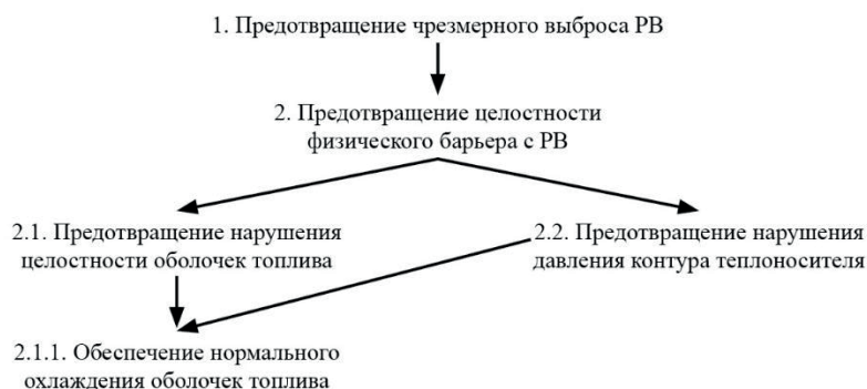
Рис. 12. Принципиальная схема выполнения основных функций безопасности по концепции пределов безопасной эксплуатации, принятой Международным агентством по атомной энергии
