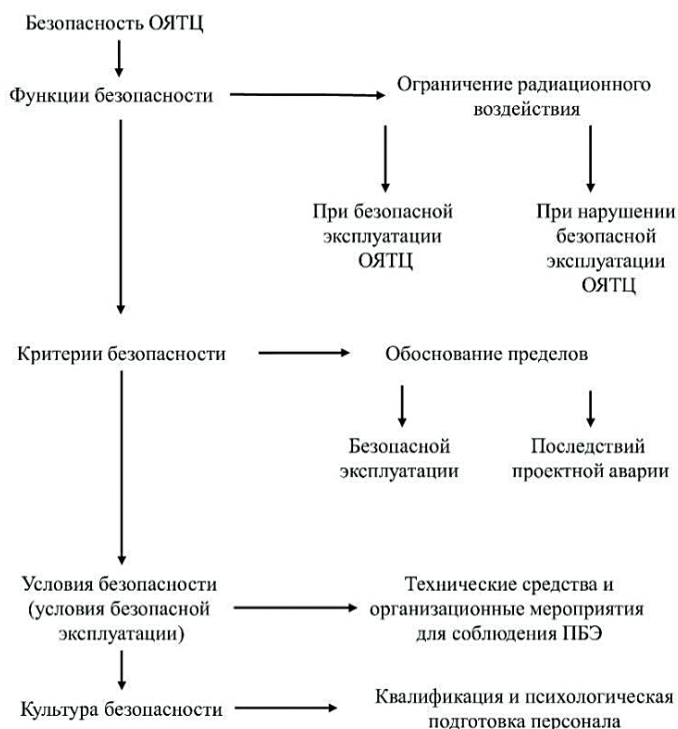
Рис. 22. Схема взаимосвязи терминов, относящихся к безопасности объектов ядерного топливного цикла
