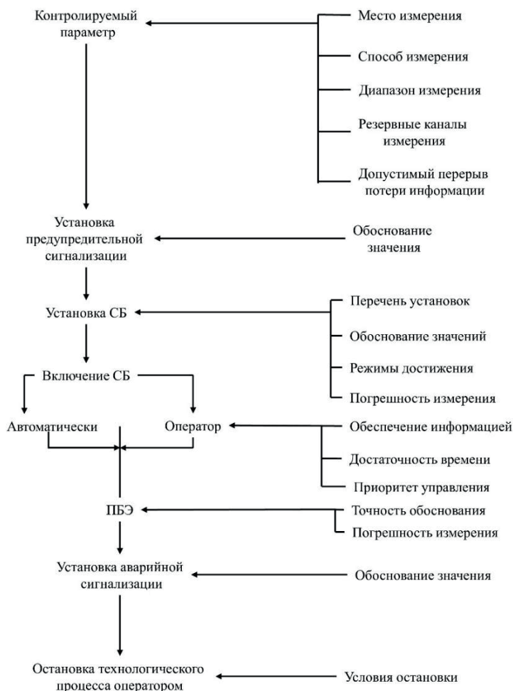
Рис. 19. Схема функционирования пределов безопасной эксплуатации ядерных установок ядерного топливного цикла по [23]
