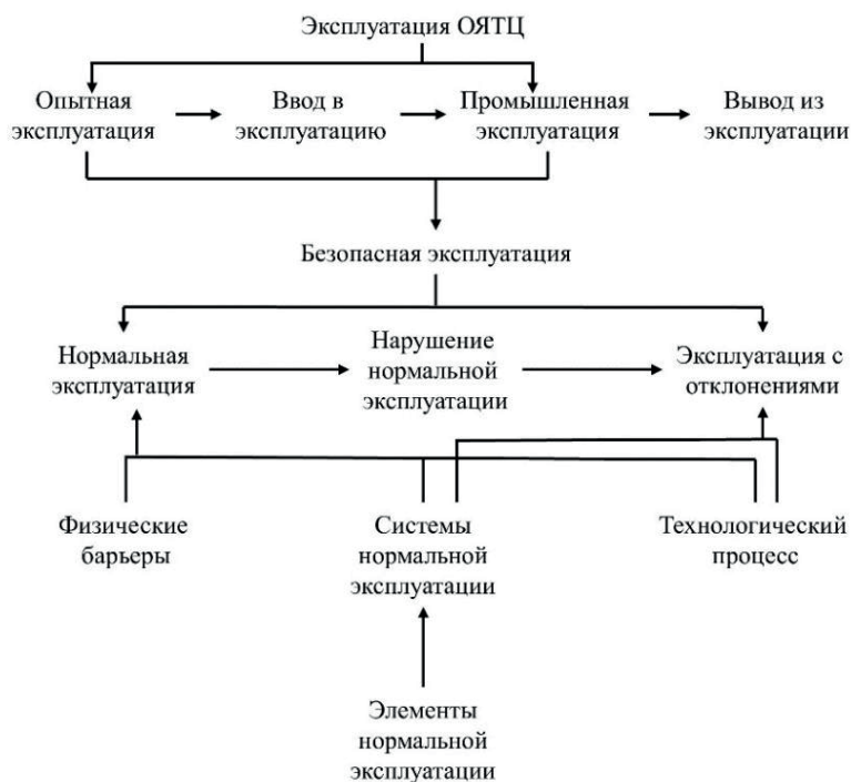
Рис. 21. Схема взаимосвязи безопасной эксплуатации с разновидностями эксплуатации объектов ядерного топливного цикла
