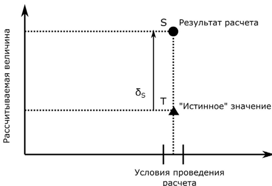
Рис. 3. Схематическое изображение относительного расположения результатов расчетов и «истинного» значения
