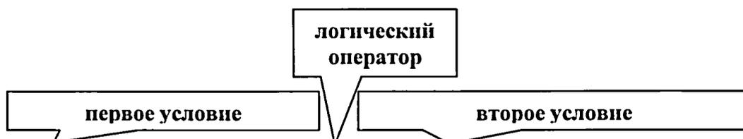
1. Если три ГЦНА находятся в работе **И** мощность реактора больше 69 %  $N_{ном.}$ , то уменьшить мощность реактора с помощью ключа ПЗ-1.
